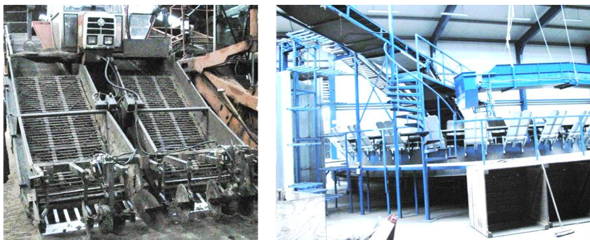
Рисунок 3 – Техника для выкопки и сортировки рассады земляники садовой.
