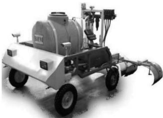
Рис. 1. Самоходный робот-опрыскиватель
