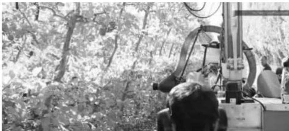
Рис. 2. Робот, способный собирать яблоки вакуумными руками
