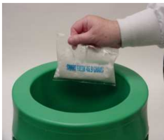
Рисунок 1 – Генератор для растворения препарата SmartFresh в воде и получения 1-МЦП.
