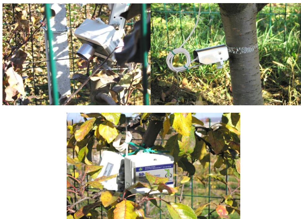
Рисунок 7 – Датчики, фиксирующие физиологические изменения во время роста дерева.
